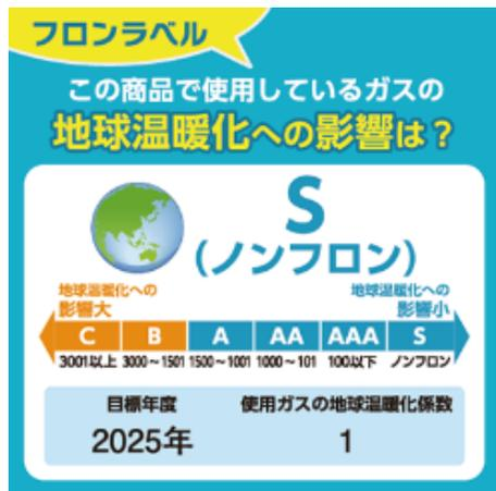
今回導入した冷却設備は、二酸化炭素（CO<sub>2</sub>）を冷媒としており、地球温暖化への影響が極めて小さい機器です。
